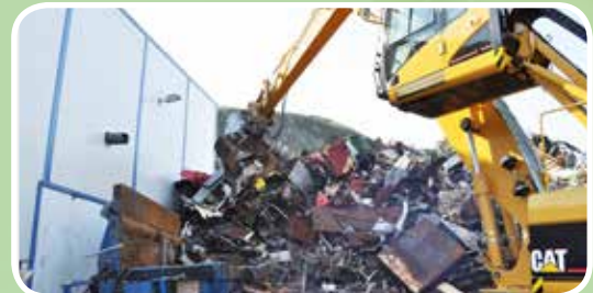
En CAT maskinhåndterer løfter jernet opp i en presse, som lager bunter for lettere håndtering og transport.
