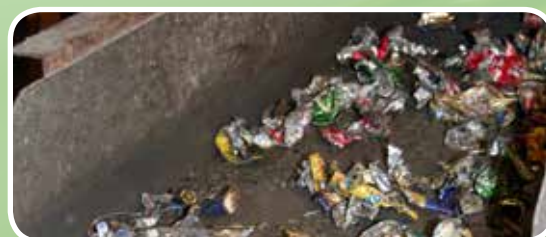
Blikk (stål) og aluminium skilles fra hverandre ved hjelp av en magnet.
