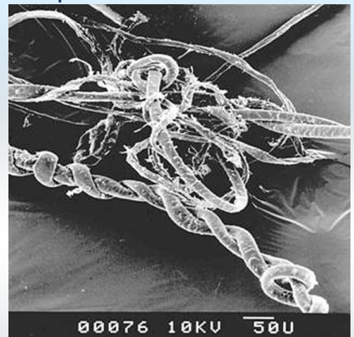
Fragmenter av mikroplast fra fortøyningsline. Lignende fragmenter, noen mindre enn 20 \mu\text{m} (tynnere enn et hårstrå), finnes på strender og i vannsøylen i hele Nordøst-Atlanteren. (foto: Dr. Richard Thompson, Plymouth University)
